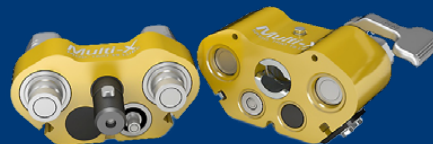
GII - Trio 19/Lube Kupplungsseite (Anschlüsse 2x G 3/4" IG + Schmiermittelleitung) - Art.-Nr. 10 932 5204
