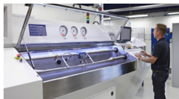
Test de débit pour huile hydraulique et eau, d'une capacité de 300 l/mn
