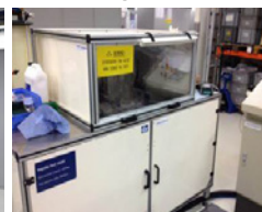
Tests d'impulsion pour pressions jusqu'à 4000 bar
