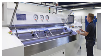
最大300 ℓ/min.までのオイル及び水の流量耐久テスト
