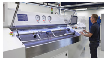
Testopstelling voor doorstroming van hydraulische olie en water, capaciteit tot 300 l/min.
