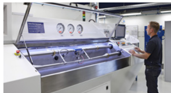
Stanowiska do badania przepływu oleju hydraulicznego i wody, wydajność do 300 l/min.
