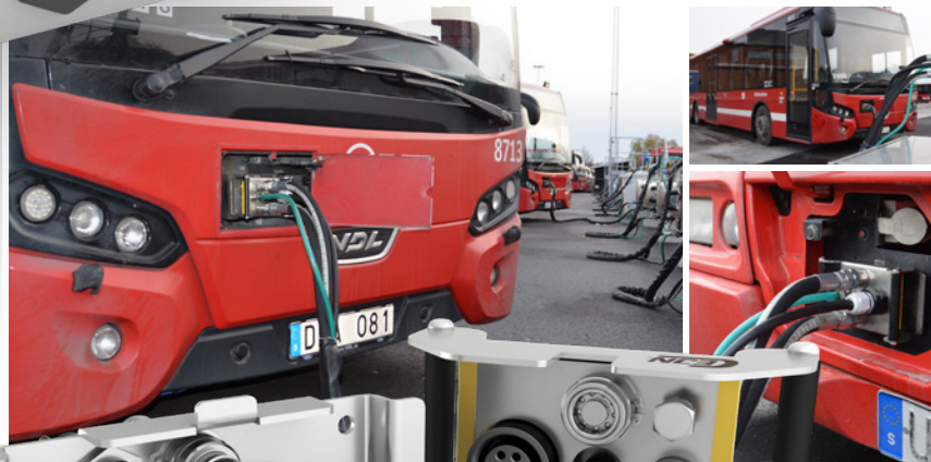
手动连接板上装有8套665系列接头和4套565系列接头。连接板采用不锈钢制造
