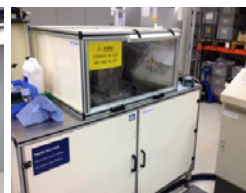
脉冲压力测试台，压力可达4000巴
