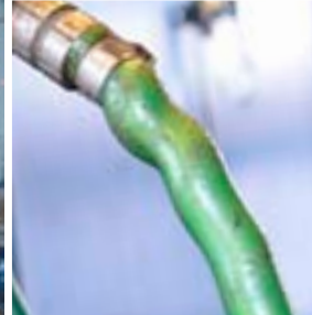
Gammel kobling, hvor slangeklemmerne skaber lækage og trykfald
