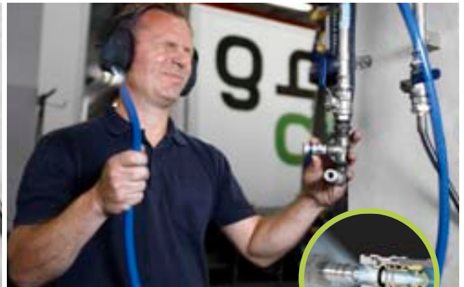
Standard - Pas de fonction anti coup de fouet
