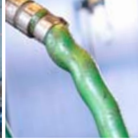
Sızdıran hortum kısıkaçı olan eski kavrama, sızıntılara neden olmaktadır
