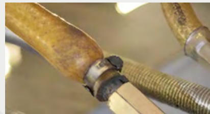
软管卡箍连接处泄漏的示例图示
